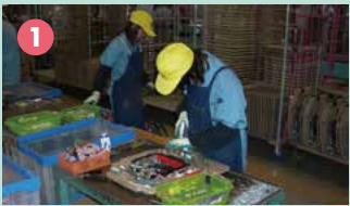
パチンコ台リサイクル事業 パチンコ店から排出されるパチンコ台、パチスロ機を高度に選別し、リユース部品、金属、木くずなどを回収 ■事業主体 株式会社ユーコーリプロ
