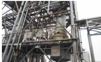
使用済有機溶剤精製リサイクル事業 液晶・半導体・医薬品などの生産工程から排出される使用済有機溶剤を、蒸留による分離技術を利用して再び高純度の有機溶剤に精製 ■事業主体 九州リファイン株式会社
