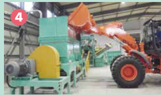
汚泥・金属等リサイクル事業 独自の「調合」技術で、多種多様な発生物(産業廃棄物)から、安定した品質のセメント原料や金属原料を製造 ■事業主体 株式会社アミタサーキュラー株式会社北九州循環資源製造所
